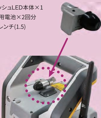
TSの望遠鏡の横に取り付けます
