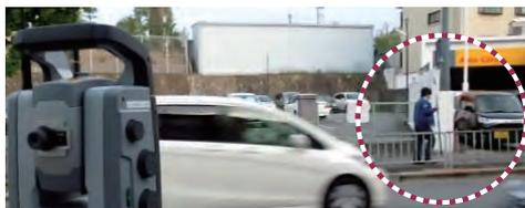
Trimble S シリーズサーボータタルステーションの「追尾継続時間設定機能」と組み合わせることにより、自動追尾が途切れた場合でも、等速で移動することで、すぐに再キャッチし自動追尾を継続しますので、スムーズな自動追尾による観測が可能です。
