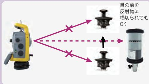
Trimble S シリーズサーボータタルステーションと同じ ID にセットにする事により、確実に追尾しますので、他のミラーを誤視準したり、その他反射物を追尾する事が無く、現況測量や横断測量等々素早く移動しながら観測する必要がある作業に非常に威力を発揮します。
